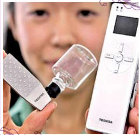
La empresa japonesa Toshiba ha desarrollado los primeros reproductores MP3 que no se alimentan de pilas convencionales o baterías sino de metanol. Toshiba ya ha estado trabajando en esta tecnología de alimentación de aparatos eléctricos mediante alcoholes (DMFC, direct methanol fuel cells) durante varios años y es pionera en este campo. Los dos modelos presentados son aún algo mayores que sus equi-
