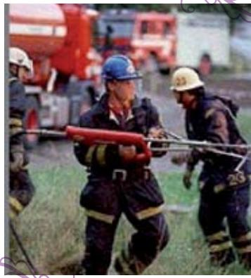
presiones de 300 bars. Se utiliza como herramienta primaria antes del ingreso de los bomberos, y se lo denomina cortante porque al flujo de agua se le agrega un abrasivo que perfora la mayoría de los materiales en los que están fabricadas las aberturas; este equipo al perforar la abertura evita la acción de abrirla para aplicar los chorros de agua de las líneas regulares y así impedir el ingreso de aire fresco.
