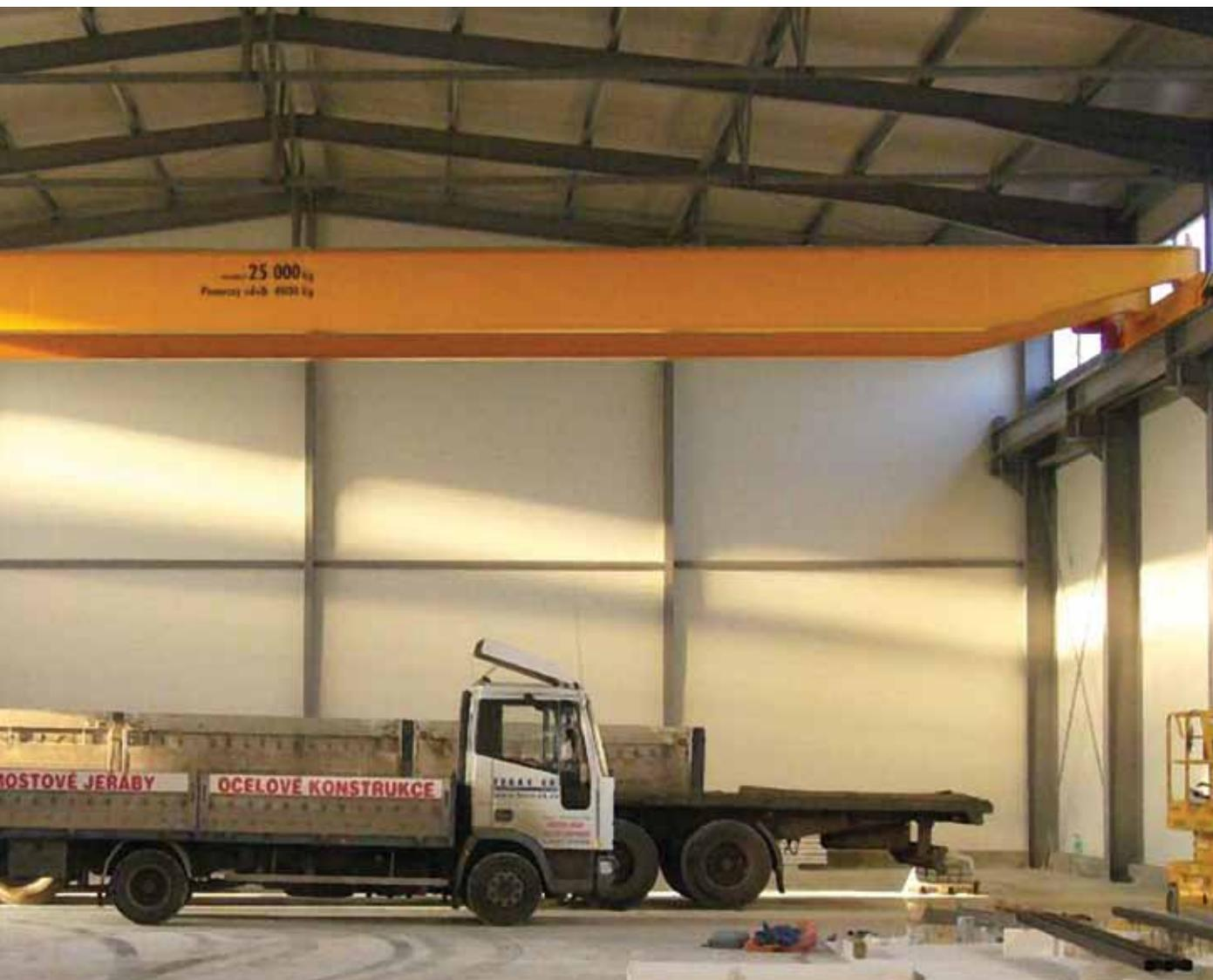
Con respecto al cable de acero, este requiere especial atención. En puentes grúa con servicio continuo el cable de acero deberá ser inspeccionado visualmente por el operador antes de iniciar su tarea. De acuerdo con la clasificación de inspecciones (que está de acuerdo con el tipo de servicio ) una inspección por personal calificado llevando registros escritos deberá realizarse entre 1 y 3 meses.
