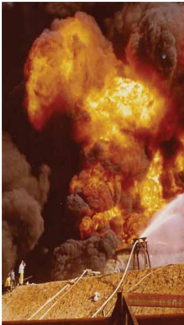
El efecto más nocivo de una BLEVE es el derivado de la radiación térmica, aspecto sobre el que se centra esta NTP. La altísima radiación térmica de la bola de fuego formada, provocará la muerte de todo ser vivo que quede encerrado en la misma y la posibilidad de propagación de incendios y BLEVE's a instalaciones y recipientes próximos generando un efecto dominó. Evidentemente la gravedad de los daños a personas y bienes estará en función de la distancia a la susodicha bola de fuego.
