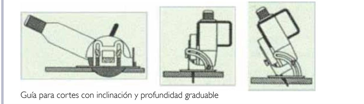
Guía para cortes con inclinación y profundidad graduable
