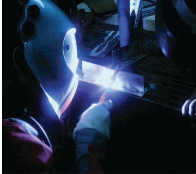
que éste no tiene un buen anclaje con las viseras de las caretas de seguridad. Por este motivo, se exponen a golpes por caídas de materiales o por los mismos elementos para soldar que no están correctamente sujetos como barandas o estructuras. Cuando los trabajadores requieren andamios y no los tienen disponibles, en algunas ocasiones improvisan superficies de trabajo que les pueden ocasionar caídas a distinto nivel, además, no utilizan arnés de seguridad.
