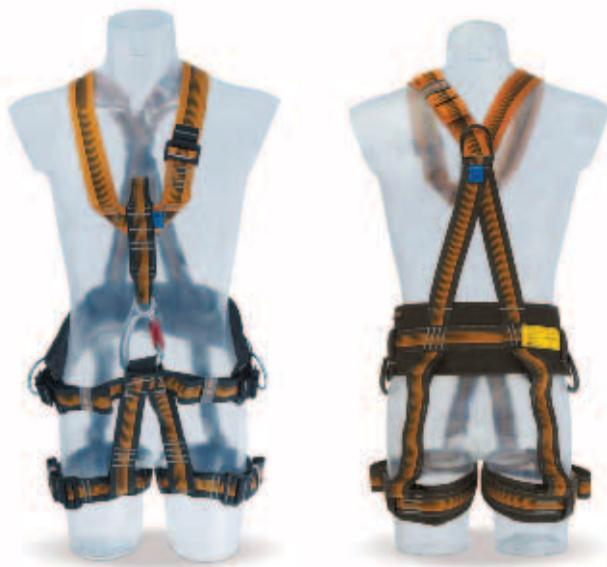
Es un dispositivo de presión del cuerpo formado por bandas textiles situadas sobre los hombros y en la región pelviana de forma que permitan sostener el cuerpo durante la caída y después de producirse ésta. Las bandas textiles están dispuestas de forma que los esfuerzos generados durante la parada de la caída se apliquen sobre las zonas del cuerpo que presentan resistencia suficiente y que, una vez que
