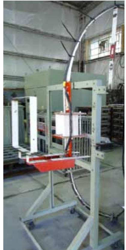
Foto 2 / Instalación de ensayo según norma IRAM 3904/04 (3)
