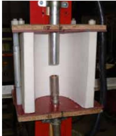
Foto 1 / Caja de ensayo según norma IRAM 3904/04 (3)
