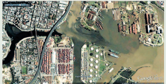
Figura 11. Área propensa a licuefacción en la Boca
